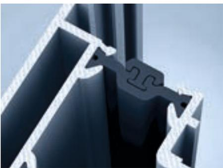
**Schritt 1:** Um den massiven Einfluss der Temperaturunterschiede auf die Funktion und die Optik der Hebe-Schiebeelemente zu vermeiden, gibt es den patentierten verzughemmenden heroal Profilverbund. Er schützt das Profil vor den schädlichen Schubkräften. Dieser Verbund besteht aus einem fest eingerollten Isoliersteg und einer Einschubfeder.
