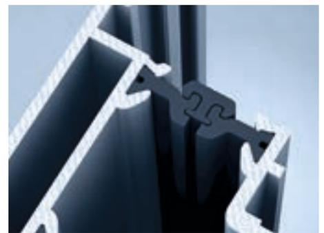
**Schritt 3:** Die Einschubfedern werden wieder eingesetzt. Der Profilverbund bleibt teilweise intakt und auftretende Schubkräfte können sich nicht auf das Getriebe und den Schließzylinder übertragen. Im Bereich des getrennten Verbunds verhält sich das Profil durch die Einschubfeder bei Querkzugkräften, die zum Beispiel bei einem Einbruchversuch auftreten, wie ein Profil mit konventionellem Verbund.
