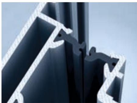
**Schritt 2:** Der Hebe-Schiebeflügel wird zunächst zugeschnitten, gefräst und gebohrt. Bevor der Flügel gepresst oder genagelt wird, wird an den Flügelprofilen die Einschubfeder entfernt. Dann wird der Isoliersteg in Teilbereichen des Flügelprofils mit einem dafür entwickelten Werkzeug aufgetrennt.
