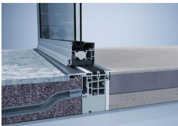
La soglia a filo pavimento dispone di due profili magnetici incassati nel telaio, che si sollevano automaticamente durante la chiusura, assicurando una tenuta perfetta a elemento chiuso. © heroal
