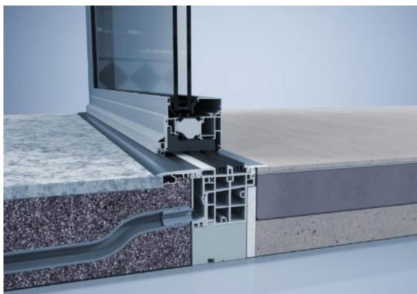
Le seuil à niveau dispose de deux profilés magnétiques encastrés dans le dormant, qui se soulèvent automatiquement pendant la fermeture. Cela assure une fermeture étanche parfaite lorsque l'élément est fermé. © heroal
