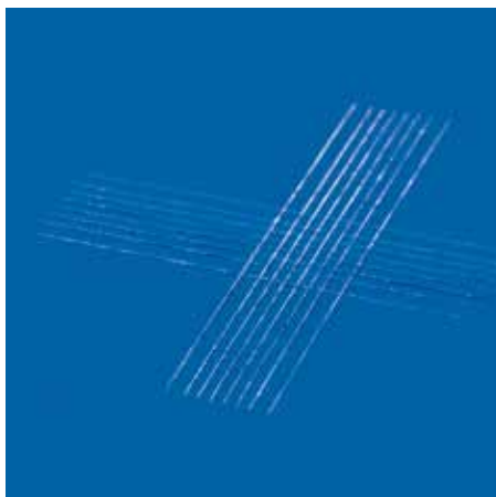
Prova di adesione con taglio trasversale.
