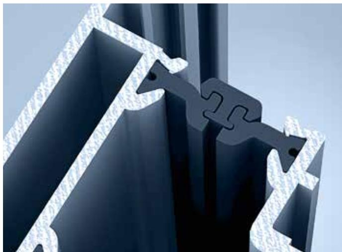
Reposant sur une fabrication innovante en trois étapes, les systèmes de porte heroal D 72 constituent une protection efficace contre l'effet bilame qui se manifeste lorsque d'importants écarts de température entre l'intérieur et l'extérieur entraînent des déformations du dormant d'ouvrant.
