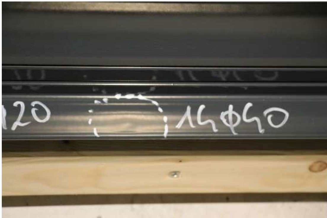
Abbildung 5: Schuss Nr. 14, 30 mm, Delle sichtbar
