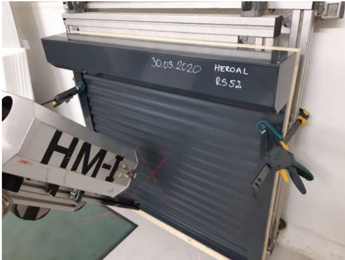
Abbildung 1: Übersichtsaufnahme Probekörperaufbau heroal RS 52 BA
