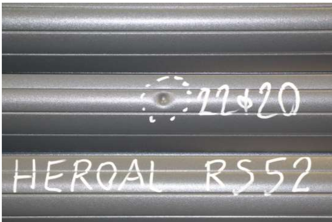
Abbildung 2: Schuss Nr. 22, 20 mm, Delle sichtbar, Rückseite
