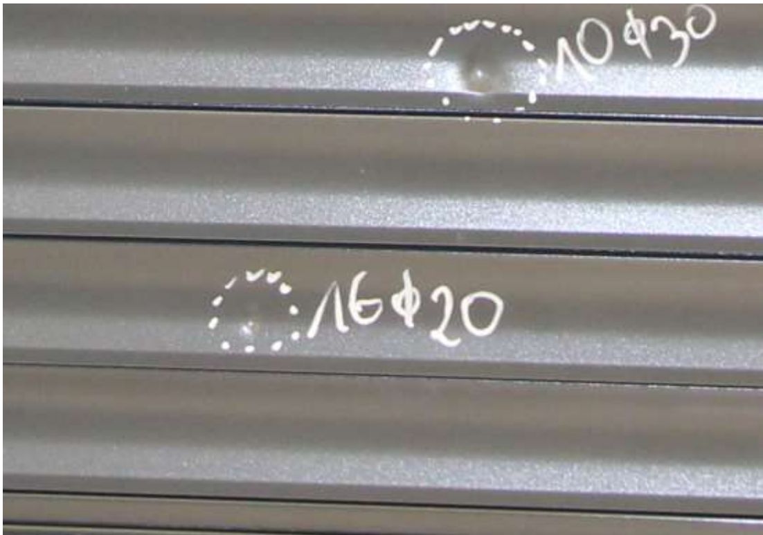
Abbildung 3: Schuss Nr. 16, 20 mm, Delle sichtbar, Schuss Nr. 10, 30 cm, Delle sichtbar
