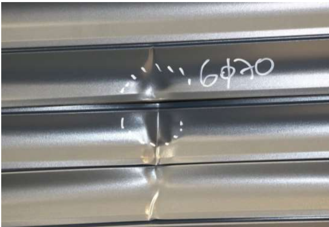
Abbildung 4: Schuss Nr. 6, 70 mm, Ausriss der Stäbe, auf- und abrollen nicht mehr möglich.
