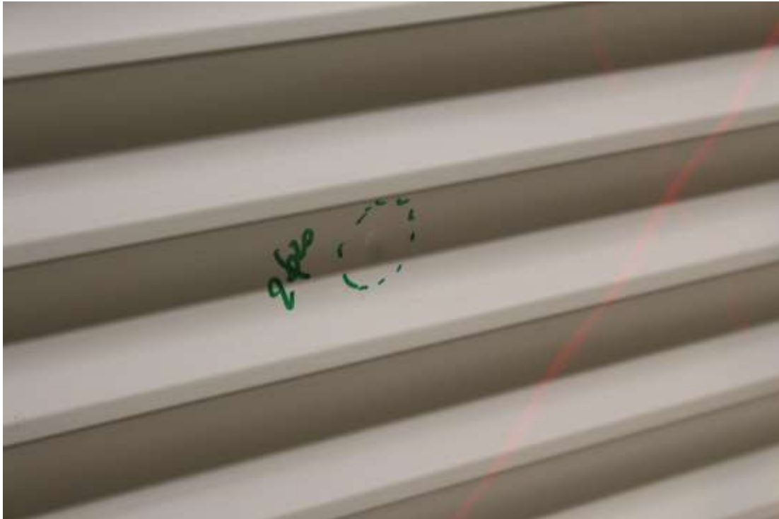
Abbildung 7: Schuss Nr. 2, 20 mm, Delle sichtbar
