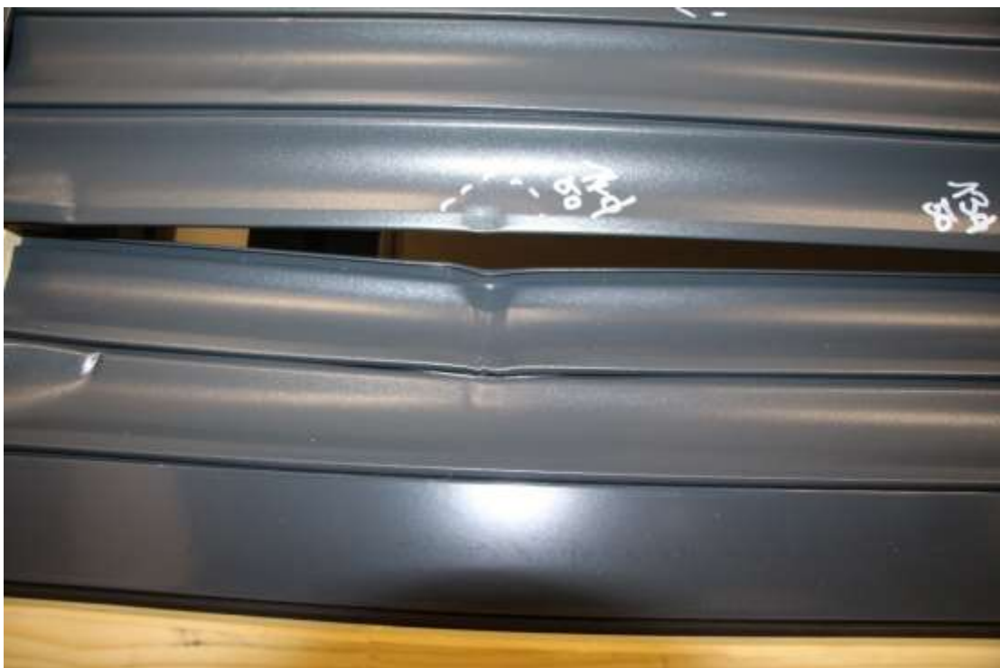
Abbildung 4: Schuss Nr. 14, 50 mm, Ausriss der Stäbe, Lichtabschirmung als auch Aufrollen nicht mehr gegeben [RS 41 SW BA]
