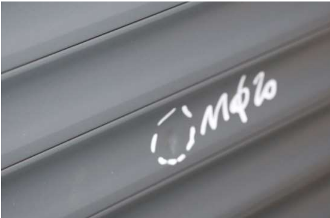
Abbildung 2: Schuss Nr. 11, 20 mm, Delle ersichtlich [RS 41 SW BA]
