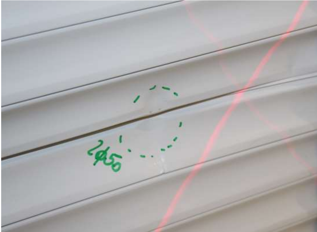
Abbildung 7: Schuss Nr. 2, 50 mm, Ausriss der Stäbe [RS 41 SW BA]
