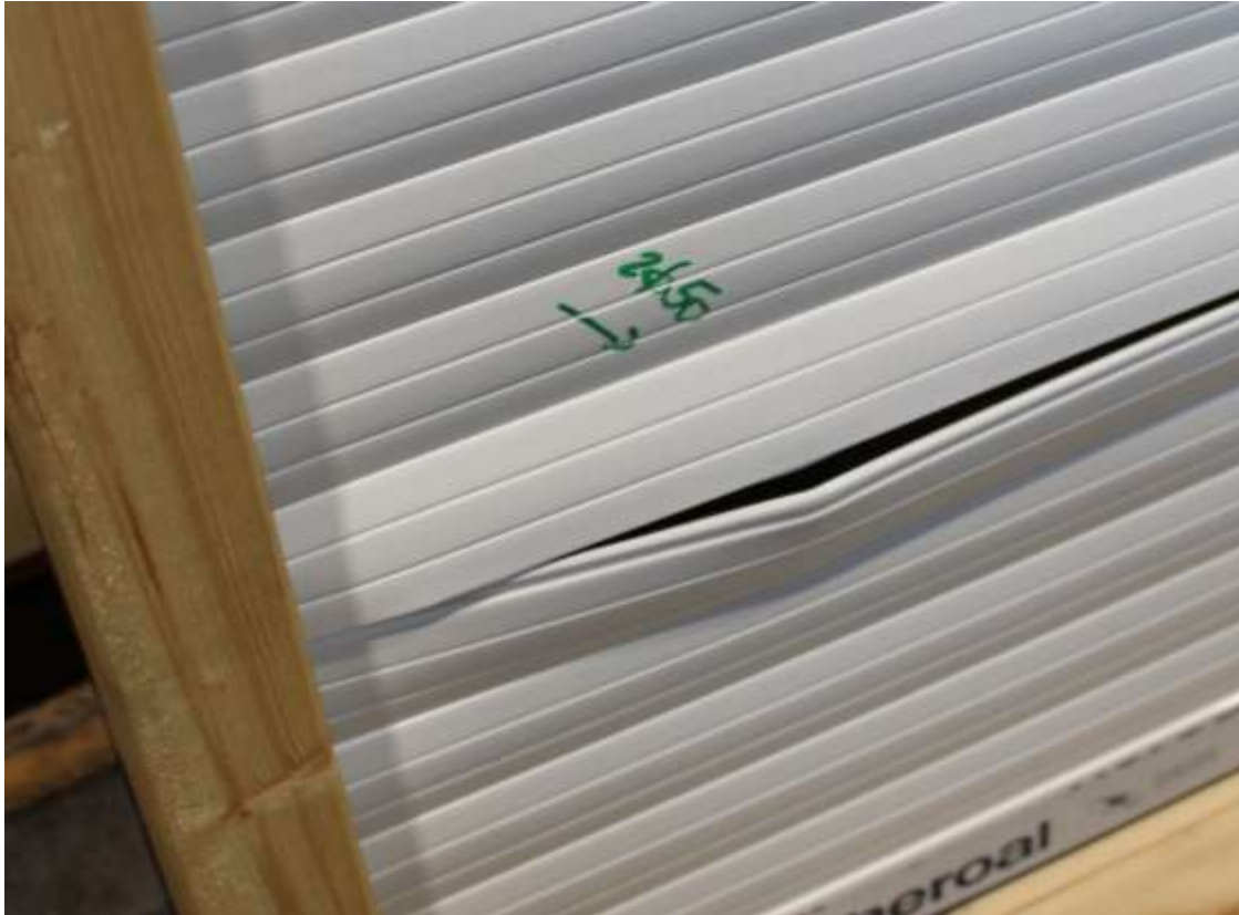
Abbildung 5: Schuss Nr. 2, 50 mm, Ausriss der Lamelle [RS 41 SW BA]
