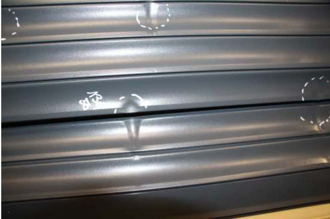
Abbildung 3: Schuss Nr. 13, 50 mm, Ausriss der Stäbe, Lichtabschirmung als auch Aufrollen nicht mehr gegeben [RS 41 SW BA]
