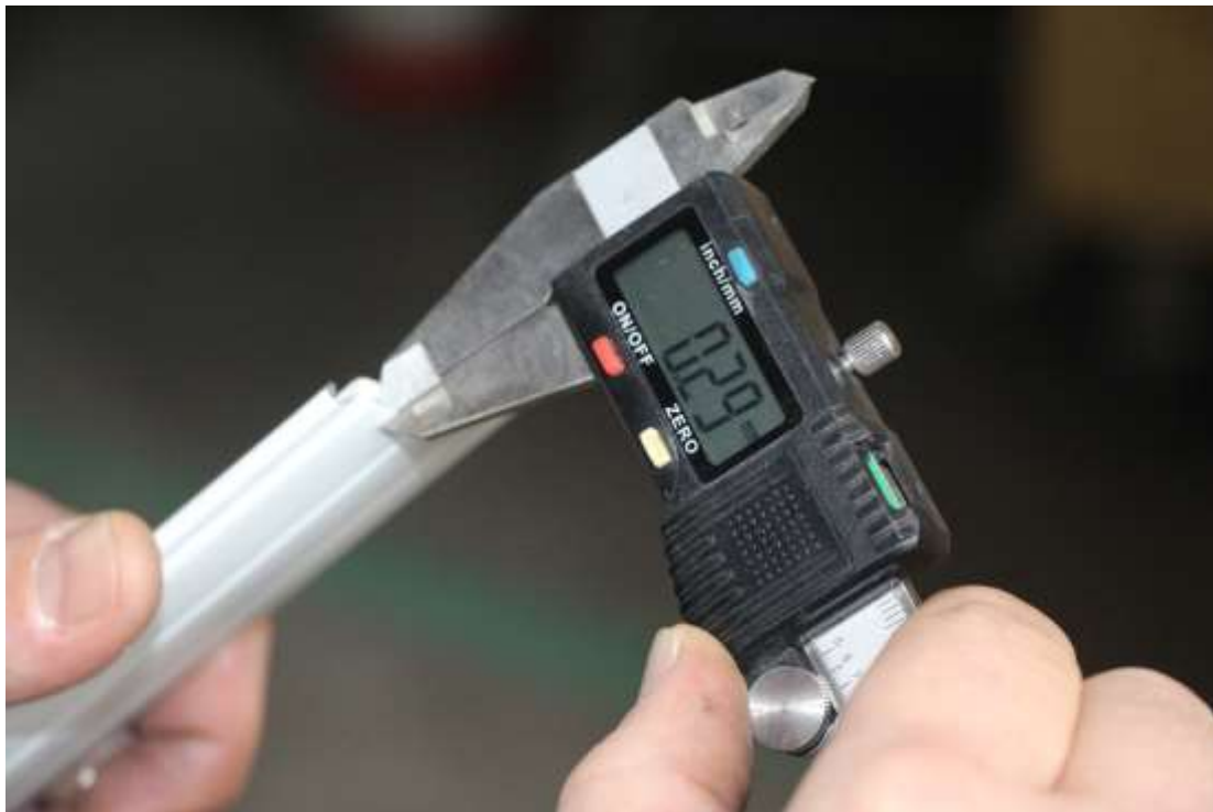
Abbildung 7: Schichtstärkenüberprüfung der Stäbe, 0,29 mm
