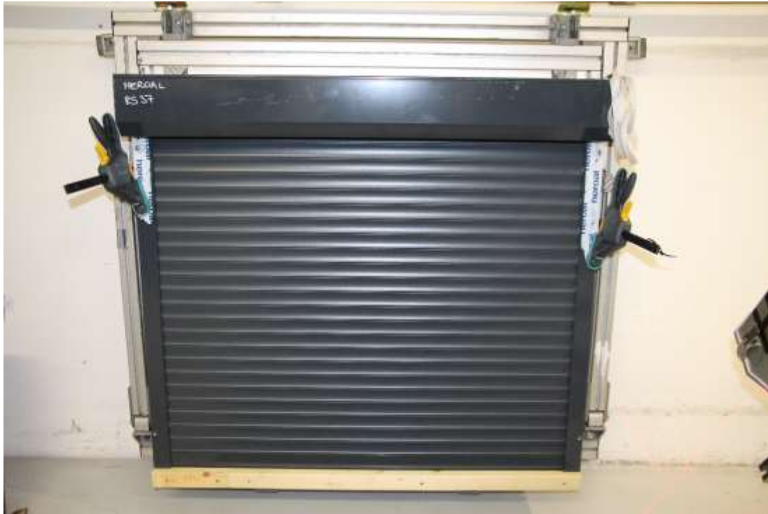
Abbildung 1: Übersicht Probekörperaufbau heroal RS 37 BA
