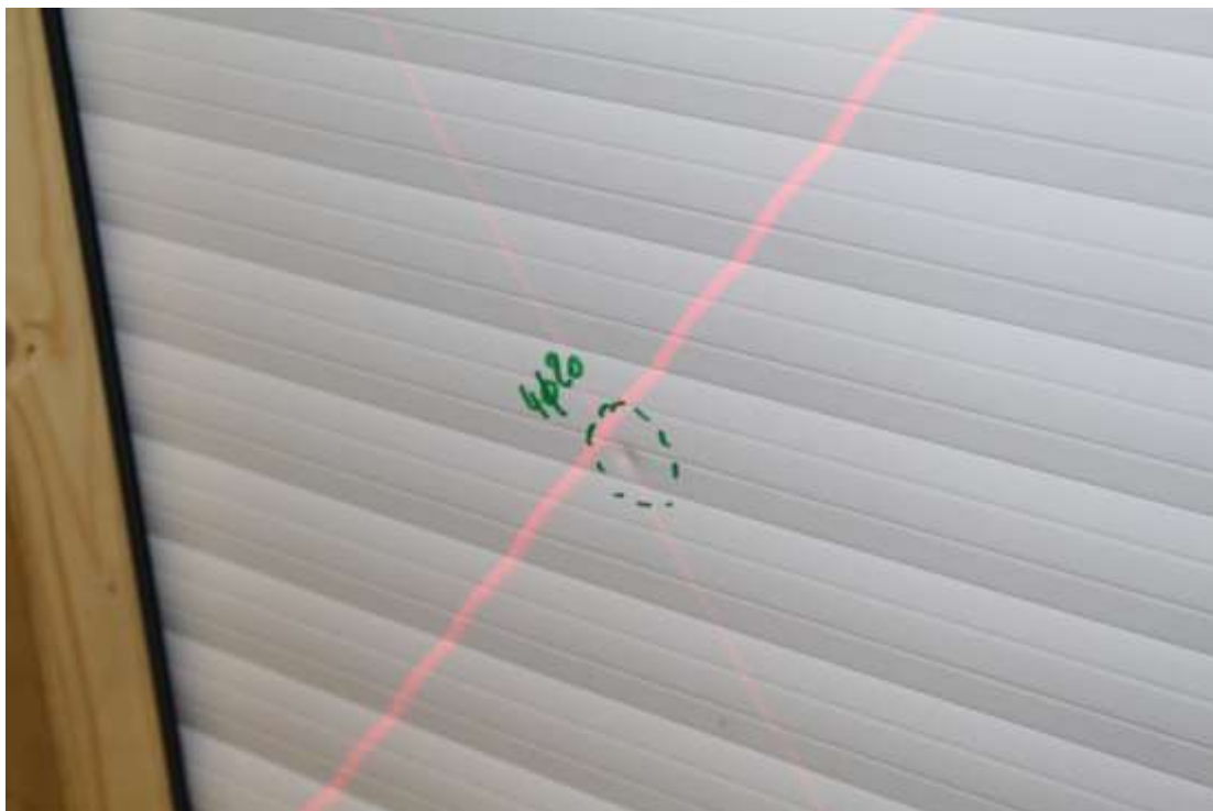
Abbildung 6: Beschuss Nr. 4 auf Rückseite, 20 mm, Delle sichtbar
