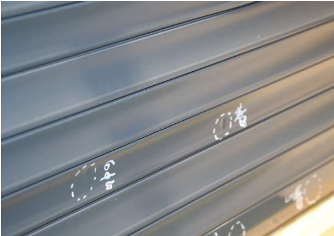
Abbildung 5: Beschuss Nr. 6 und 7, je 20 mm, Dellen sichtbar
