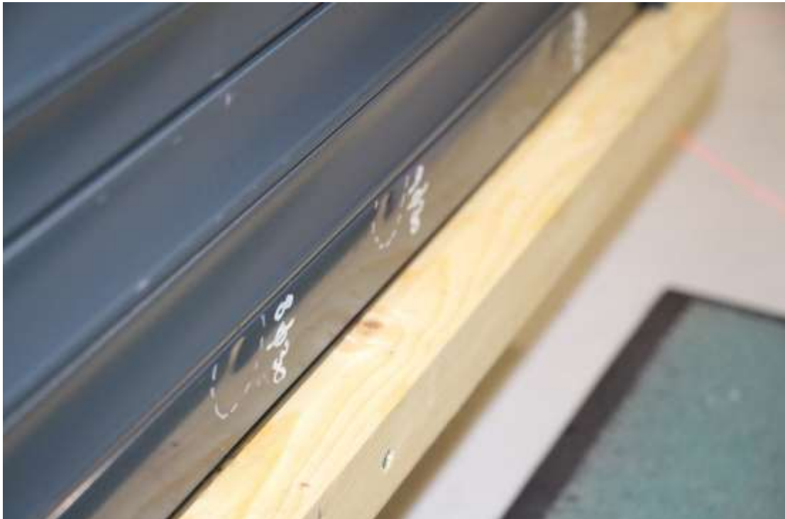
Abbildung 4: Beschuss der Endleiste mit 30 mm Eiskugeln, Dellen sichtbar
