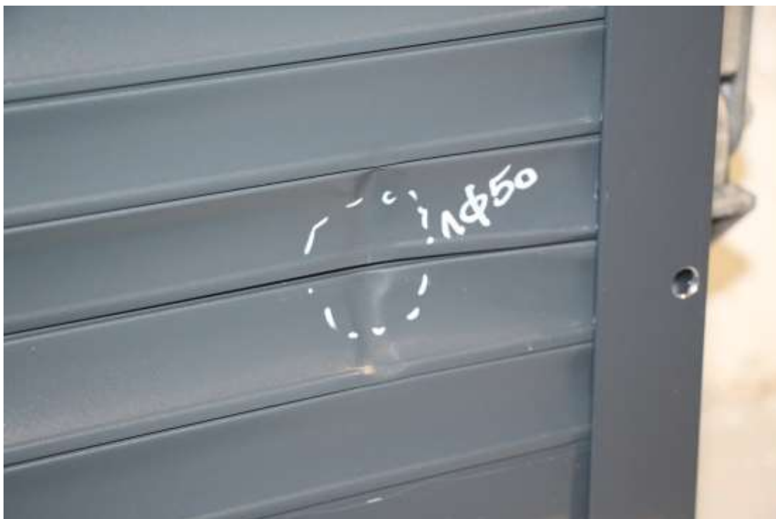
Abbildung 2: Schuss Nr. 1, 50 mm, Stäbe entkoppelt, kein Aufrollen mehr möglich
