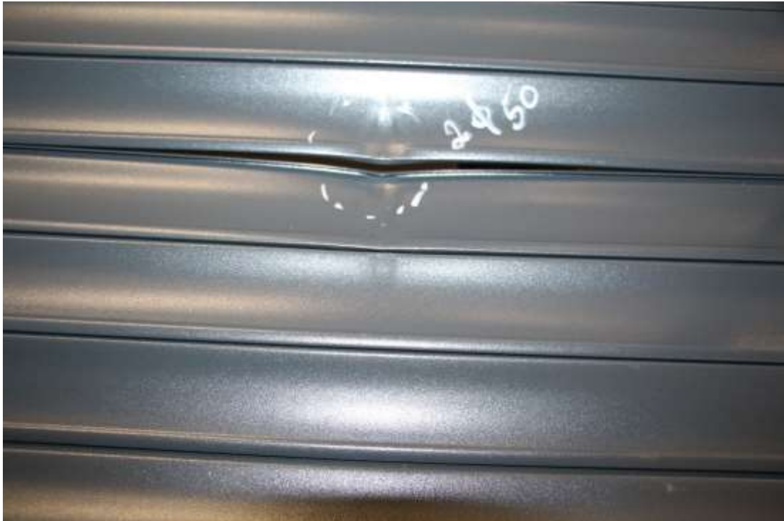
Abbildung 3: Schuss Nr. 2, 50 mm, Stäbe entkoppelt, kein Aufrollen mehr möglich
